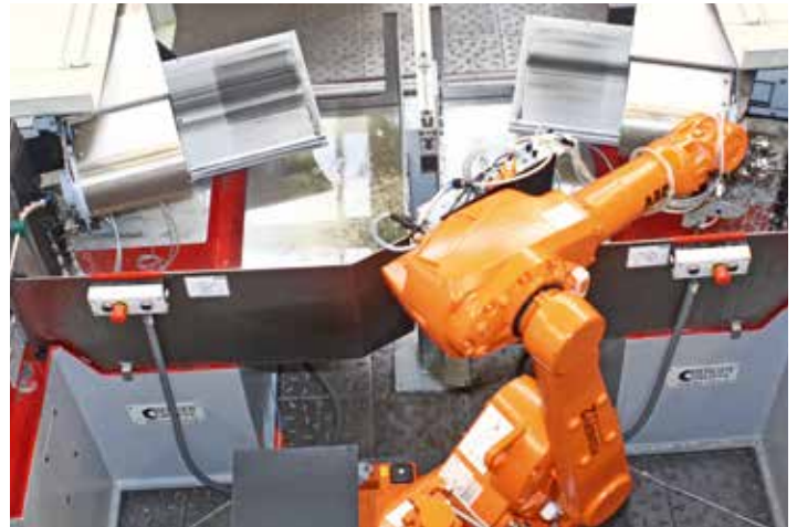
Roboterzelle mit zwei 5-Achsen-CNC-Schleifmaschinen für Messer
