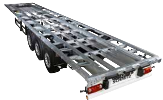
Das aus kaltgeformten Einzelkomponenten zusammengebolzte GENIOS-Chassis
