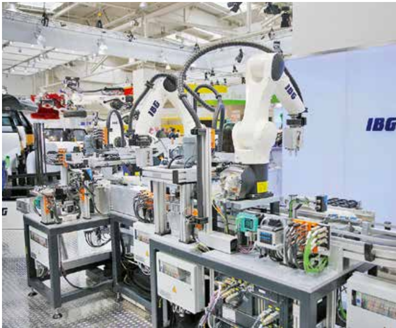
Vollautomatische Logistiksysteme mit Robotik-Achssystemen zum Handling von pharmazeutischen Substanzen
