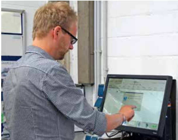
Der OTEC-BDE-Monitor zeigt den Mitarbeitern genau den Status aller Aufträge an. So ist eine lückenlose Überwachung der Produktionsprozesse möglich.
